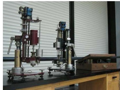
Prototipos de goniómetros Weissenberg verticales. Diseñados por J. L. Amorós (1920-2001). Construidos en el Dpto. de Cristalografía Física del CSIC (1960)
