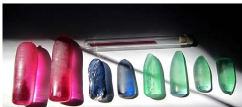
Boules de corindón obtenidas por el método de Verneuil (fusión).- En 1902 Auguste Verneuil describió el proceso comercial de síntesis del rubí.
