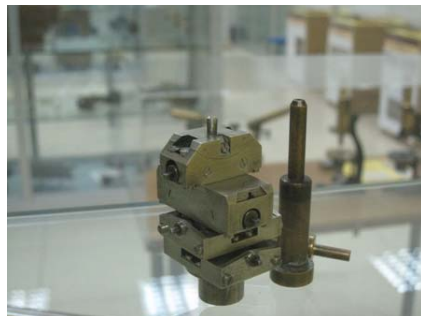
Prototipos de goniómetros Weissenberg verticales. Diseñados por J. L. Amorós (1920-2001). Construidos en el Dpto. de Cristalografía Física del CSIC (1960)
