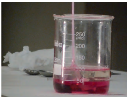
Figura 4. Obtención de una hebra de nailon 6-10 utilizando fenolftaleína que colorea la fase acuosa alcalina.
